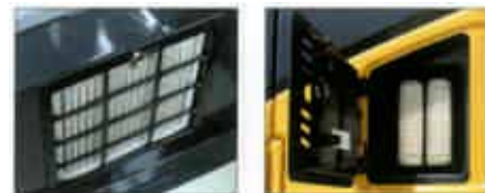
Filtro interno do ar condicionado
