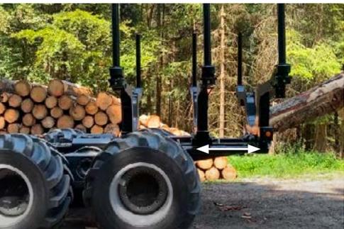
A opção *caixa de carga extensível* é ideal se você deseja uma máquina flexível de classe média, mas ocasionalmente precisa transportar sortimentos mais longos. A caixa de carga extensível oferece a flexibilidade de poder estender facilmente a área de carga quando necessário e, em seguida, restaurá-la rapidamente ao seu tamanho anterior. O guindaste é usado para ajustar facilmente a posição da caixa de carga a partir da cabine. Essa opção está disponível no Komatsu 845 e no Komatsu 855.
