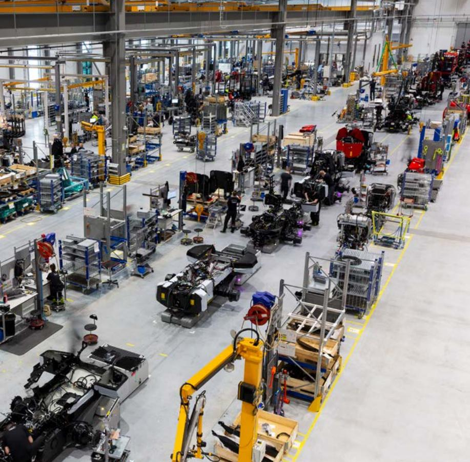
No salão de montagem, as peças do depósito são montadas para formar uma máquina florestal completa. A montagem é dividida em diferentes áreas:
