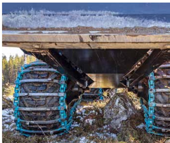
Avec le bogie portique, la garde au sol est la meilleure possible pour les porteurs comme pour les abatteuses.
