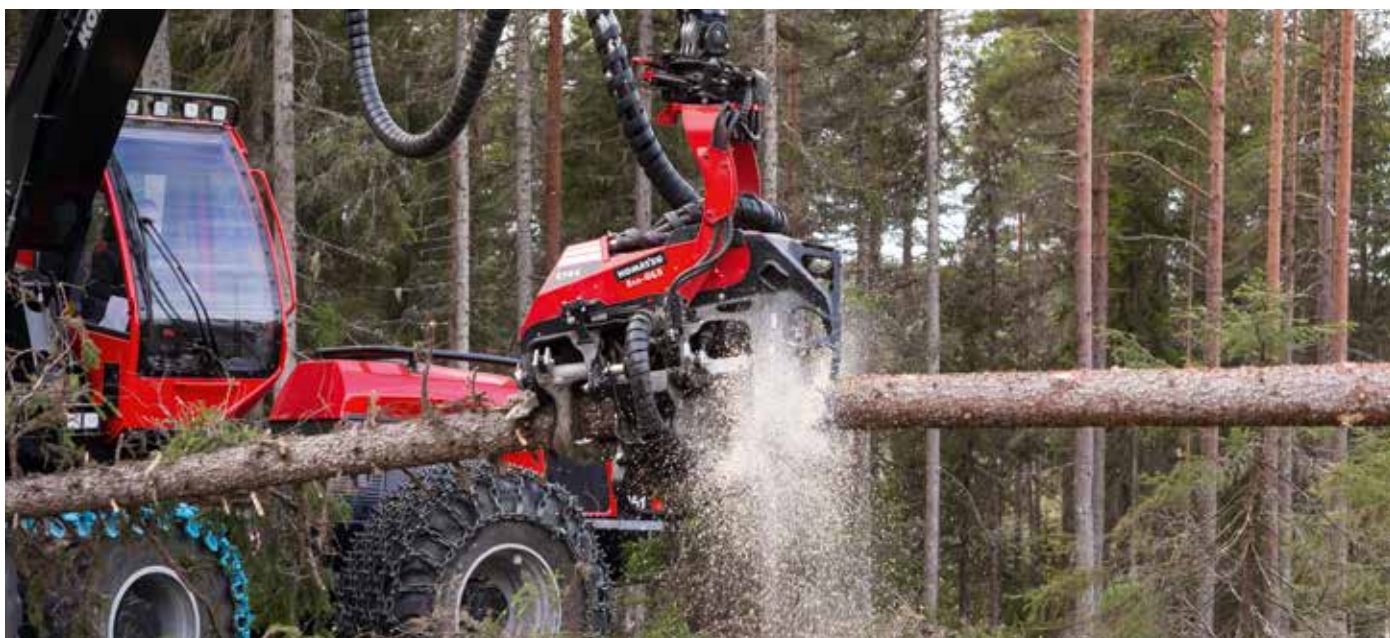
Con una cadena engrasada se reduce el impacto ambiental. El sistema ECO-GLS está disponible como opción para los cabezales Komatsu C93, C123, C124 y C144.
